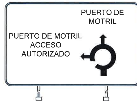
CARTEL GLORIETA ACCESO ESTE 1 ud. Dimensiones 3m * 2m
